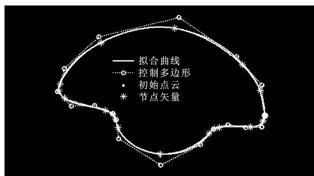
图10 凸轮 II 模型的曲线拟合
